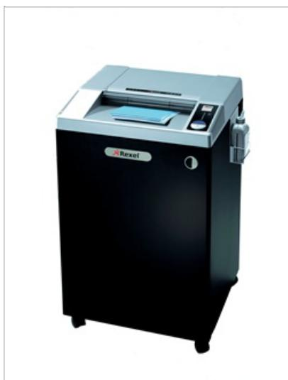
Besonders breite Öffnung, hohe Performance! Der RLW47 ist mit einem 405 mm breiten Eingabeschlitz ausgestattet und kann somit auch DIN A3 verarbeiten - Zeichnungen oder Endloslisten sind für ihn kein Problem. Er schneidet pro Durchgang bis zu 47 Blatt (80 g/m<sup>2</sup>) DIN-A4-Papier in 6 mm breite Streifen (Sicherheitsstufe P-2). Das Auffangvolumen des mit 225 Litern besonders großen, ausziehbaren Abfallbehälters liegt bei 1.700 Blättern.
