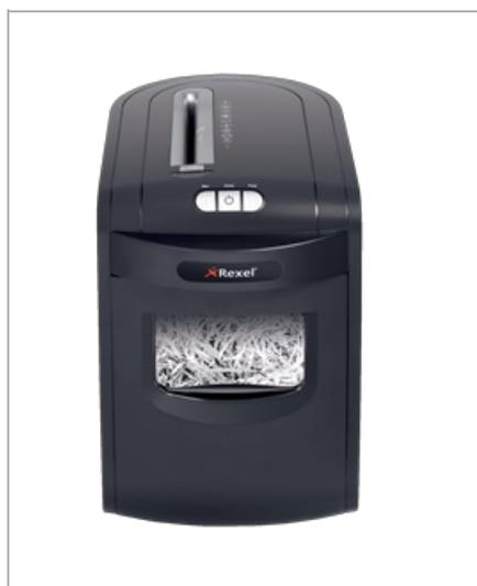
Pas de bourrage, pas de stress, pas de désordre ! Doté de la technologie anti-bourrage à détection continue, le destructeur Mercury™ REM723 coupe croisée micro détruit jusqu'à 7 feuilles (80 g/m<sup>2</sup>) en particules de 1,9 x 15 mm (P-5). Sa corbeille de 23 litres peut contenir jusqu'à 250 feuilles dans un sac en papier recyclé.
